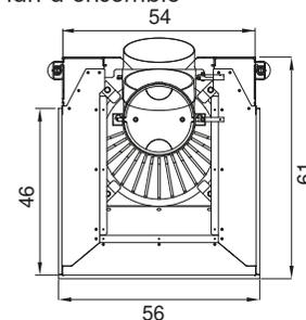
(Sortie du conduit de fumée également possible à l'arrière)
