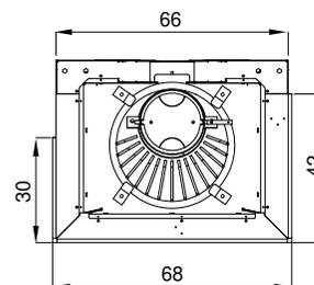
(Sortie du conduit de fumée également possible à l'arrière)
