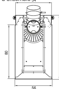
(Sortie du conduit de fumée également possible à l'arrière)
