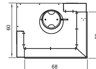
(Sortie du conduit de fumée également possible à l'arrière)
