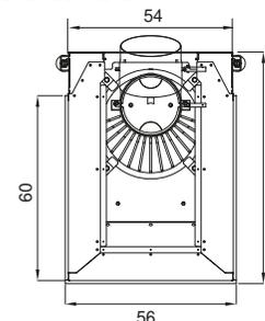
(Sortie du conduit de fumée également possible à l'arrière)
