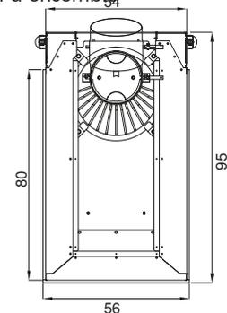
(Sortie du conduit de fumée également possible à l'arrière)
