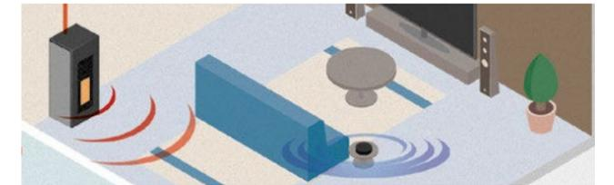
Les poêles à granulés JØTUL peuvent être équipés d'une sonde de température déportée qui offre la possibilité d'afficher et réguler la température de votre pièce. Cette sonde peut être associée à chaque sortie d'air chaud canalisable pour les appareils équipés de cette technologie.
